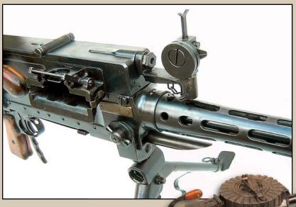
Hausse et guidon de l'arme. IL s'agit d'organes de visée pour mitrailleuse d'aviation, conservés pour cette arme à usage terrestre. On peut rencontrer divers types d'organes de visée sur la MG 30 (t).
