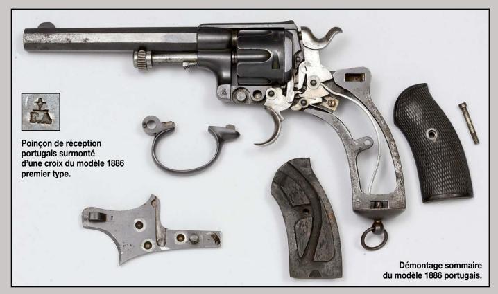
croître la vitesse initiale de 17,87 m/s. La petite tirette de plaquette de crosse est supprimée, la tige/axe est légèrement modifiée et la finition est sensiblement moins soignée que sur le revolver d'officier.
