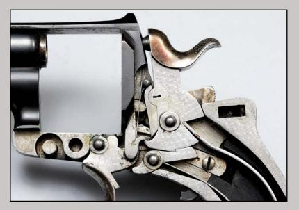
Détail du mécanisme du revolver 11mm, la portière est abaissée, le chien est débrayé.
