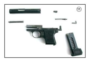
geur de 5 cartouches, entièrement logé dans la poignée, mais dans les années soixante, un chargeur à extension contenant 8 cartouches et dépassant légèrement de la poignée fut proposé aux utilisateurs dotés de mains trop grandes pour pouvoir utiliser confortablement le pistolet dans sa configuration d'origine.
