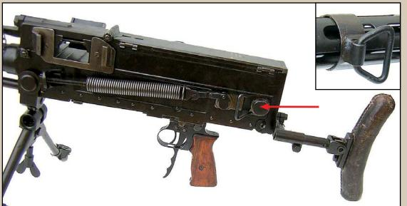
Lors de la transformation de l'arme pour l'usage terrestre, un anneau de bretelle a été ajouté du côté gauche du boîtier (flèche) et sur un anneau entourant le radiateur.
