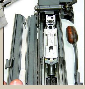
Le couvercle du boîtier est articulé sur son côté gauche. On peut aisément le basculer pour accéder au mécanisme.
